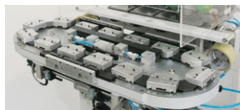
Transportadores de accionamiento servo de diferentes medidas
