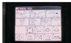
Panel de control PLC de pantalla táctil
